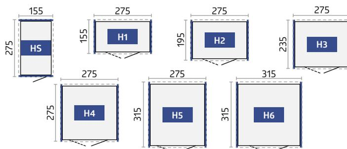
**CONSEIL :** à partir de la taille H2, vous pouvez tourner le HighLine® en fonction de vos besoins et installer la porte standard sur n'importe quelle paroi latérale. À partir de la taille H4, la double porte peut aussi être montée sur un côté.
