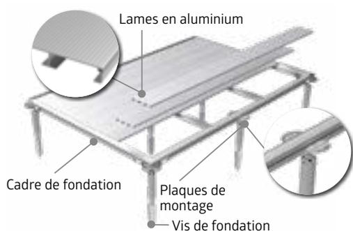
**Durée du montage :** 2 à 4 heures à deux (selon la dextérité et le produit concerné). **Outils requis :** perceuse à percussion, foret Ø 40 x 570 mm, niveau à bulle, perceuse, clés de SW13 et SW24, pelle.
