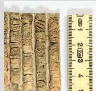
Un contrôle minutieux des bois réalisé par des prélèvements du bois de cœur par perçage garantit une durabilité maximale.
