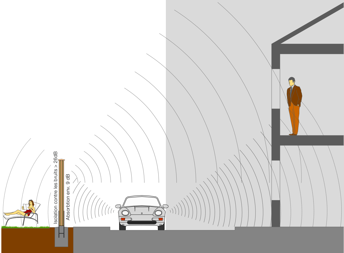
Le niveau de bruit d'une route à forte fréquentation est d'env. 80 dB
